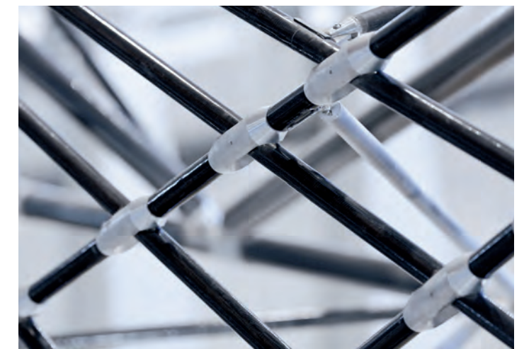
CFK-Strukturen und Werkzeughalter einer Hochgeschwindigkeits-Portalfräse zur Bearbeitung von Urformen im Schiffbau.
