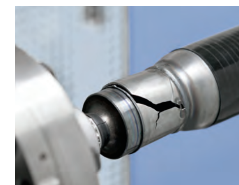
Ermüdungsbruch im metallischen Anschlussflansch einer Faserverbundantriebswelle.
