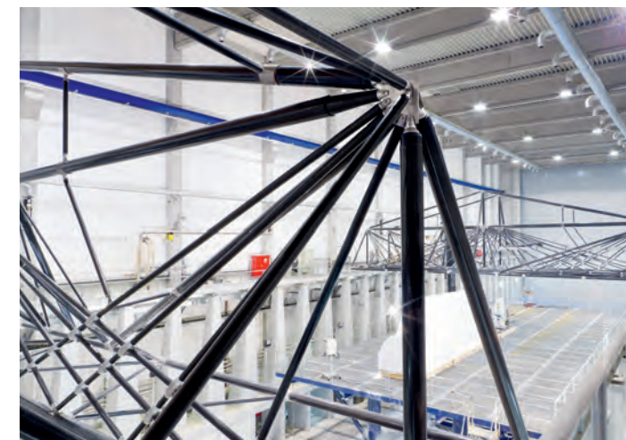
CFK-Strukturen und Werkzeughalter einer Hochgeschwindigkeits-Portalfräse zur Bearbeitung von Urformen im Schiffbau.
