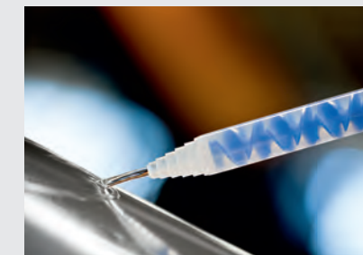
Spezialharze bilden die Matrix eines duromeren Verbundwerkstoffes.
